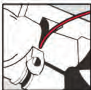
U-Bügel-Draht in Bohrung festklemmen und abwinkeln für rechten und linken Schenkel bei leicht geöffneten Zange Bending U-shaped body wire
