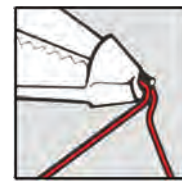
Abbiegen des Adams-Klammerfußes und Abwinkeln des Drahtes Bending an angle of Adams-clamp-tooth
