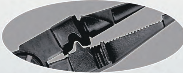
Biegen des Labialaußenbogens Bending of labial outer bows
