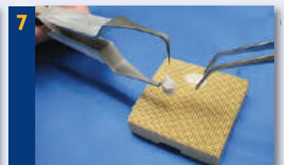
7 Platzieren auf dem Brenntäger mithilfe einer Pinzette Placing on the firing tray using a forceps
